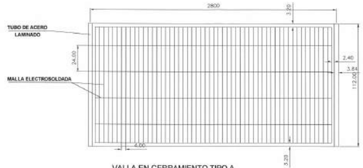
VALLA EN CERRAMIENTO TIPO A ESCALA 1:25
