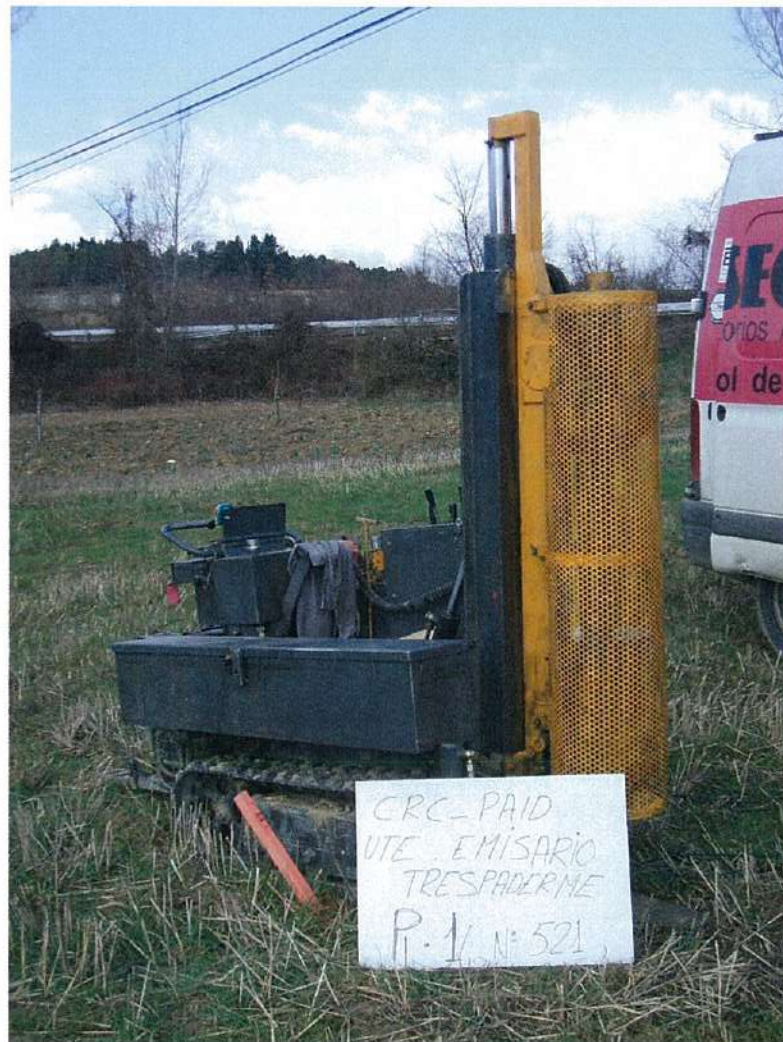
ENSAYO DE PENETRACIÓN DINÁMICA D.P.S.H. N° 1
